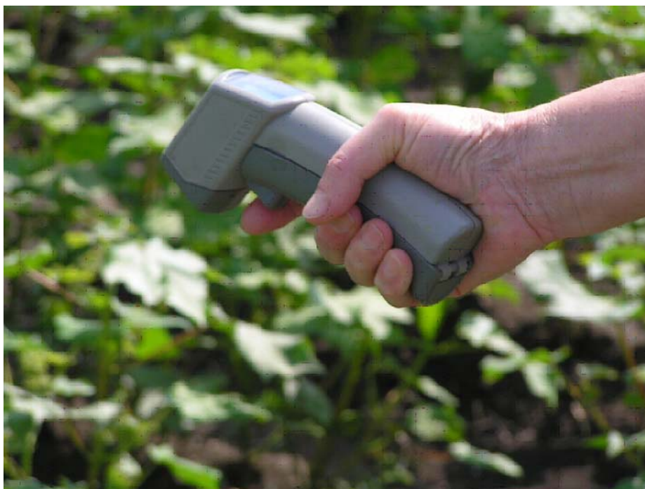
Фиг. 4. Инфрачервен термометър за пространствени измервания в полето Fig. 4. Infrared thermometer for spatial field measurements
