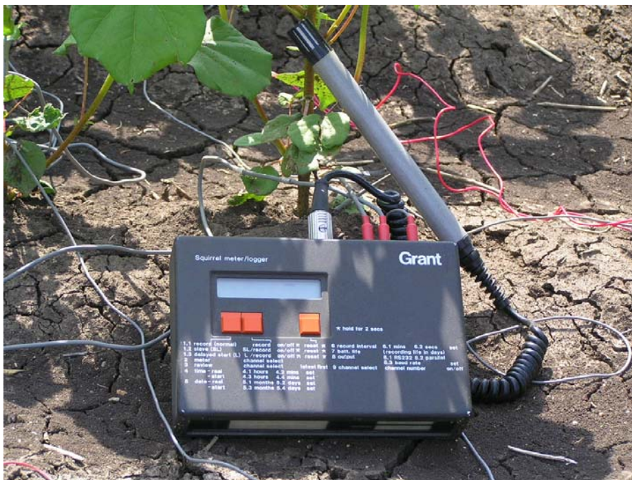
Фиг. 3. Многоканален уред за температурно-влажностни измервания на полето Fig. 3. Multichannel device for temperature-humidity measurements on the field
