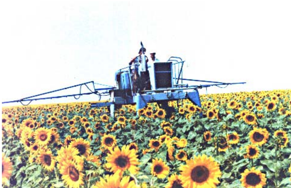
Фиг. 2. Тракторна пръскачка с висок просвет при пръскане на семепроизводен посев слънчоглед с етеричномаслени емулсии
