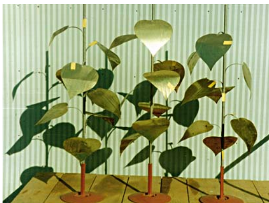
Фиг. 1. Макети на слънчогледови растения с листчета водочувствителна хартия
